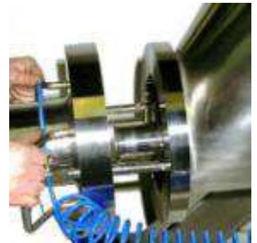
Palier vis de mélange, démontable : Extraction vis en la tirant dehors
