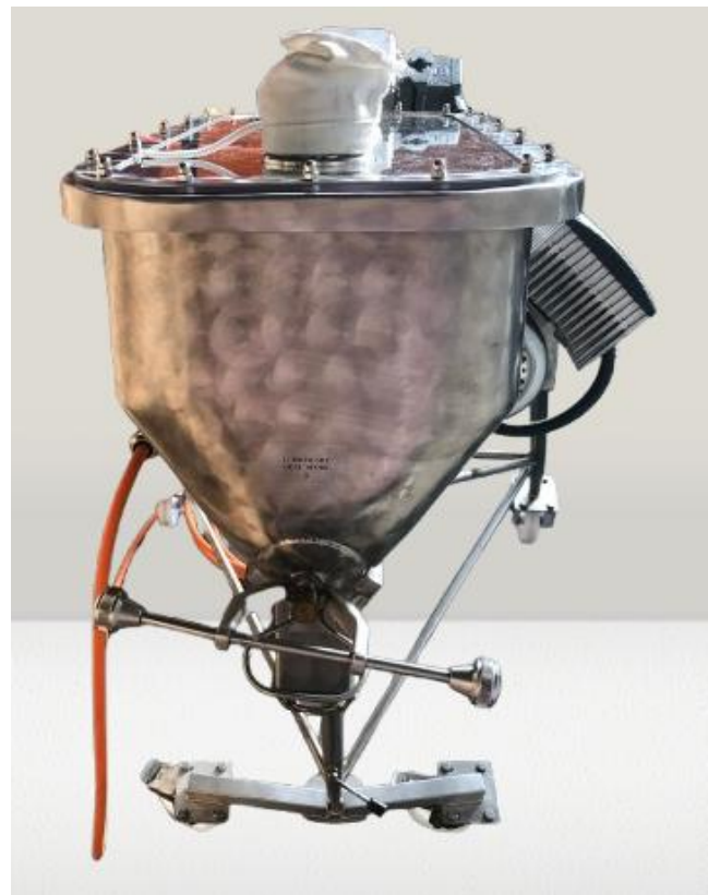
Abb. rechts Ansicht Produktauslauf und Endlager Mischschnecke
