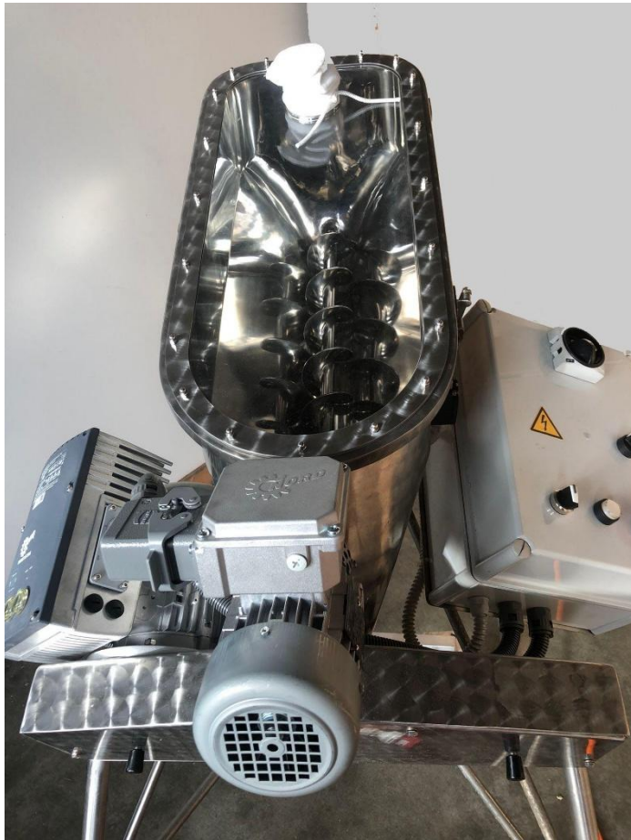
Abb. Links Mischbehälter innen poliert. Deckel transparent
