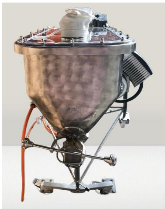
Fig. à droite Vue sortie produit et palier opposé vis de mélange
