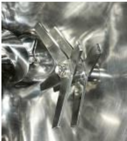
Fig. à gauche Couteaux à haute fréquence- Lames : 2 rangées
