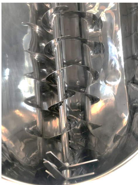
Fig. à gauche Cuve de mélange polie à l'intérieur avec couteau, lames double rangée
