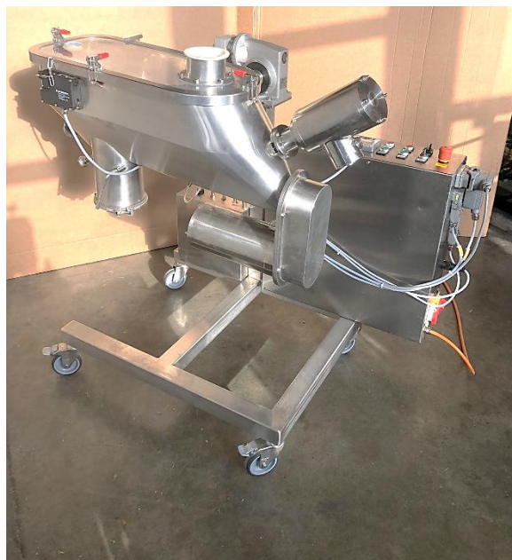
Fig. à gauche Cuve de mélange polie à l'intérieur avec couteau, lames double rangée
