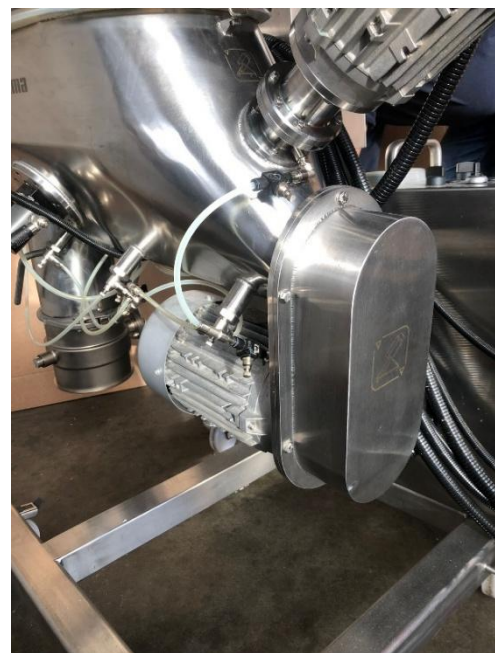
Fig. à droite Système d'entraînement vis de mélange
